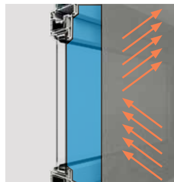
Außenliegender Sonnenschutz wirkt effektiv: Die Reflexion der Sonneneinstrahlung liegt bei vielen Geweben über 60 %.
